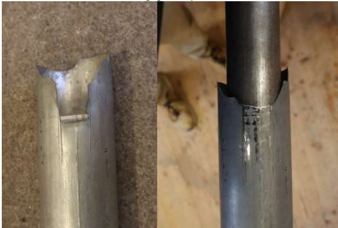
Abbildung 16 Reparatur defekter Stimmündungen
