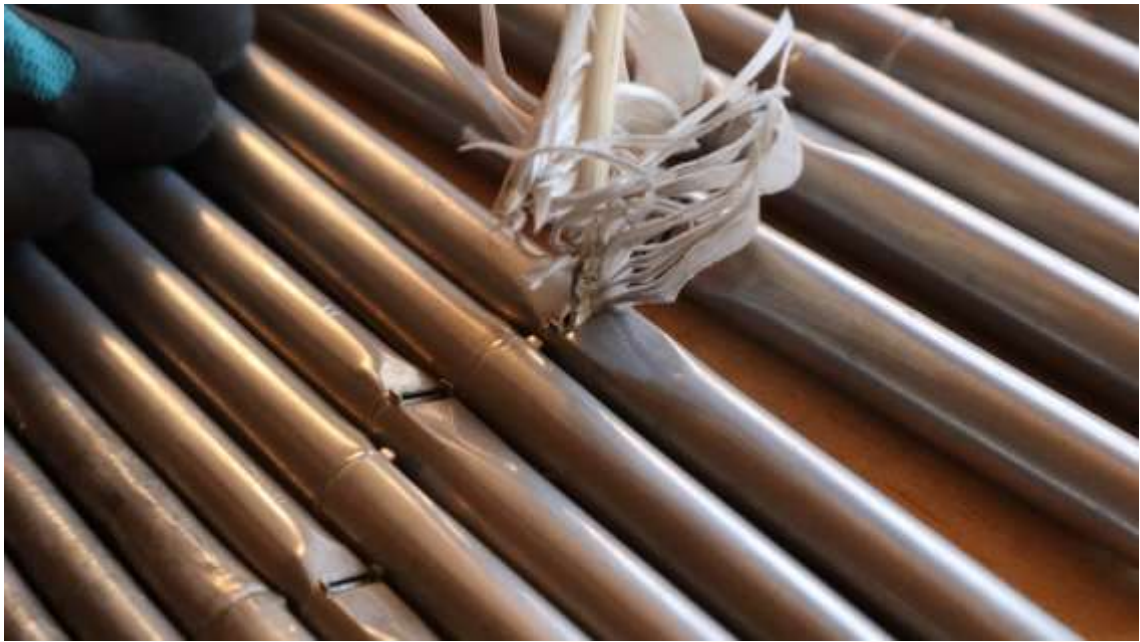
Abbildung 15 Reinigung der Kernspalten
