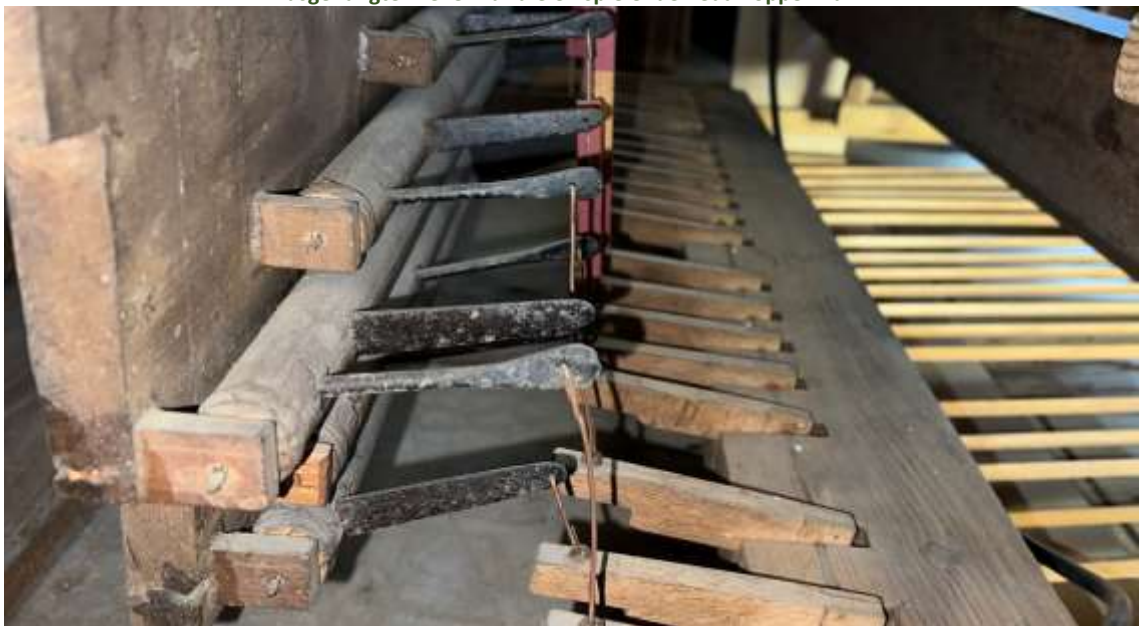
Abbildung 43 Alte und nachträglich geänderte Wellenärmchen des Pedals v.d.R.
