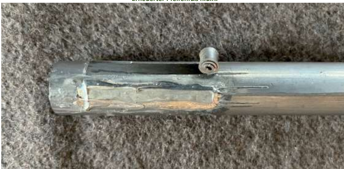
Abbildung 21 Zugelötete Stimmrollen Gamba 8' v.d.R.
