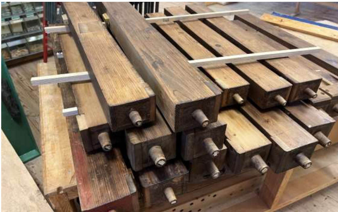
Abbildung 28 Holzpfifen beim Trocknen nach den Holzwurmbehandlung w.d.R.
