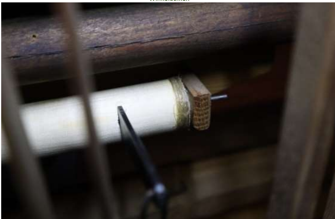
Abbildung 46 Rekonstruierte Welle mit brüniertem Eisenärmchen n.d.R.
