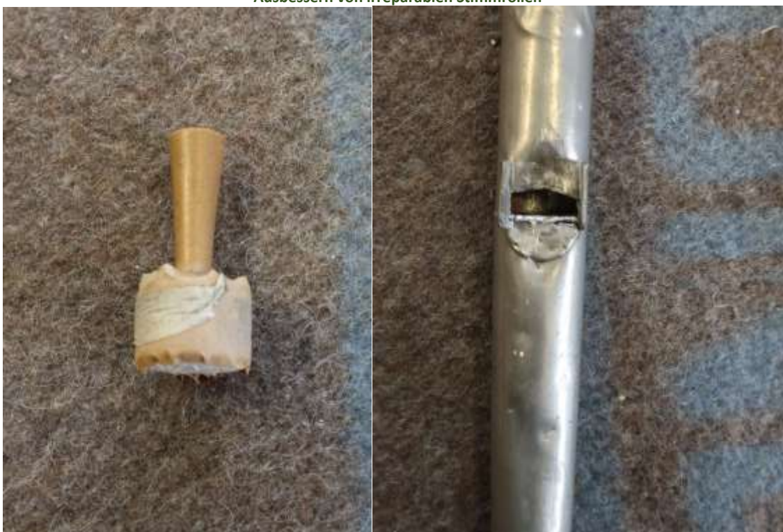
Abbildung 18 Spund mit Klebeband (links) v.d.R. und defekte Pfeife Gedeckt 8' (rechts) v.d.R
