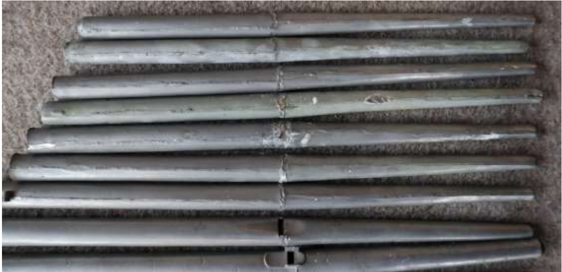
Abbildung 22 Löt-nähte und Reparaturstellen Diskantbereich Gamba 8' v.d.R.
