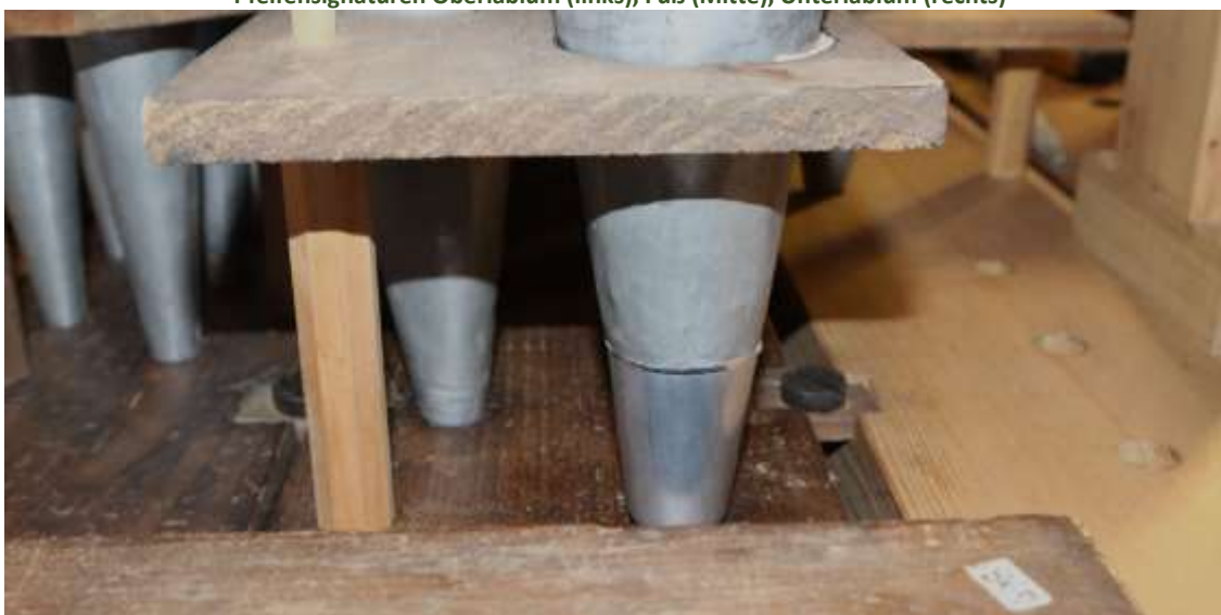
Abbildung 20 Erneuerter Pfeifenfuß n.d.R.
