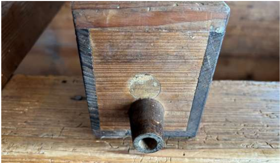
Abbildung 30 Aus der Mitte versetzte Pfeifenfüße
