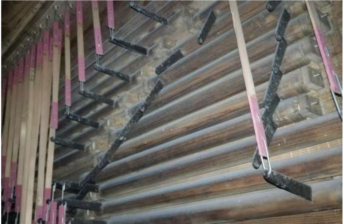
Abbildung 42 Ausgehängte Wellen für die einspielende Pedalkoppel v.d.R.
