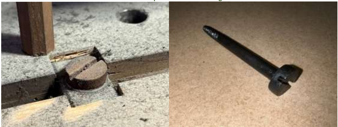
Abbildung 41 Entrosten und Brünieren der Stockschrauben
