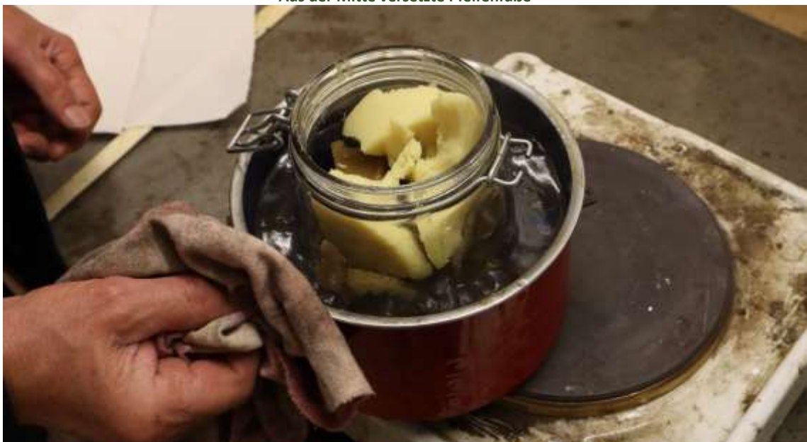
Abbildung 31 Herstellen der Holzwurmpaste
