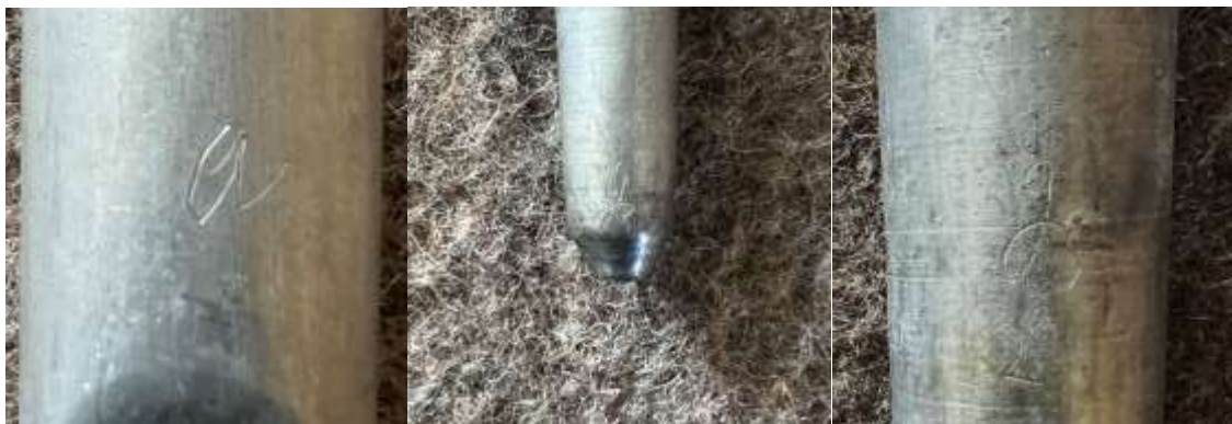
Abbildung 19 Pfeifensignaturen Oberlabium (links), Fuß (Mitte), Unterlabium (rechts)
