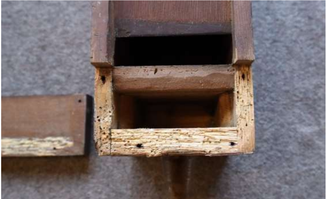
Abbildung 24 Verwurmter Kernbereich Prinzipal 8'
