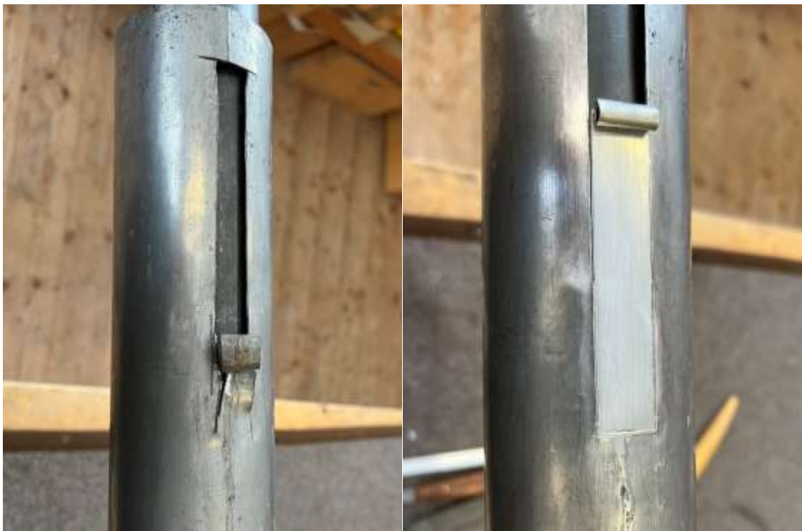
Abbildung 17 Ausbessern von irreparablen Stimmrollen
