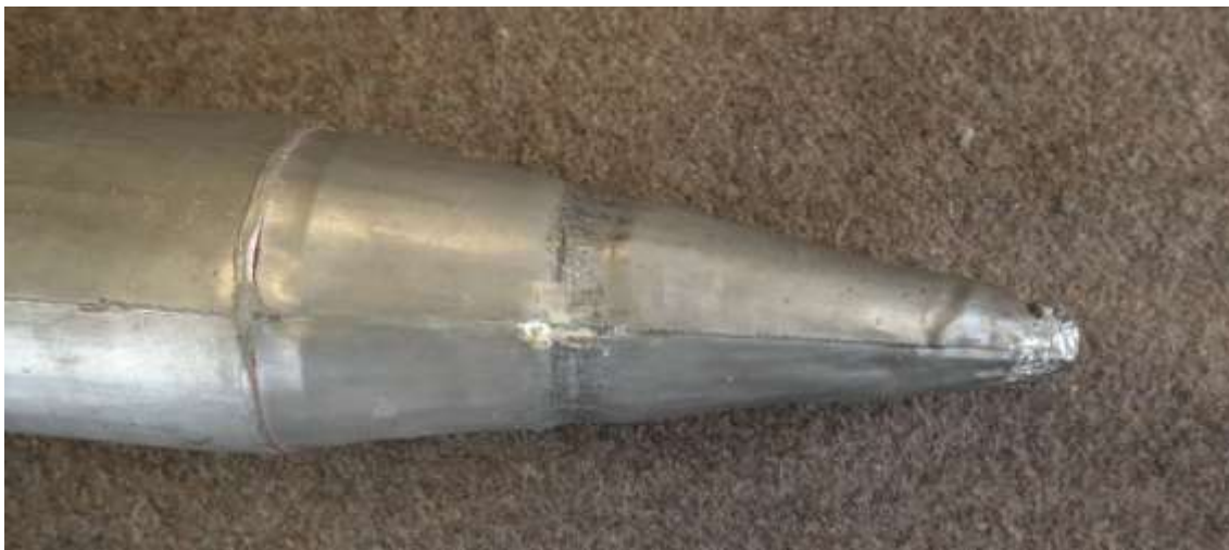
Abbildung 10 Eingedellte Pfeifenfüße vor der Restaurierung v.d.R.
