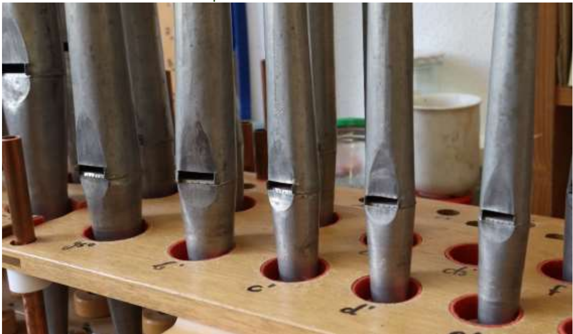
Abbildung 23 Pfeifen auf der Intonierlade in der Werkstatt w.d.R.
