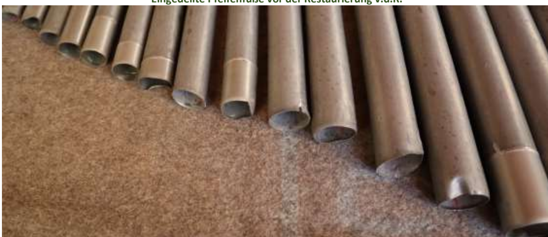
Abbildung 11 Verbeulte Pfeifenmündungen v.d.R.
