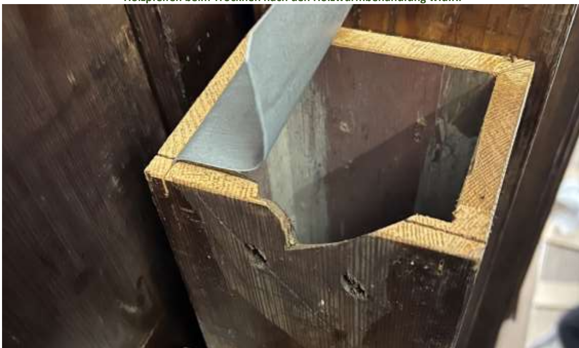
Abbildung 29 Jüngerer Sägeschnitt und Rückstände der originalen Stimmkerbe
