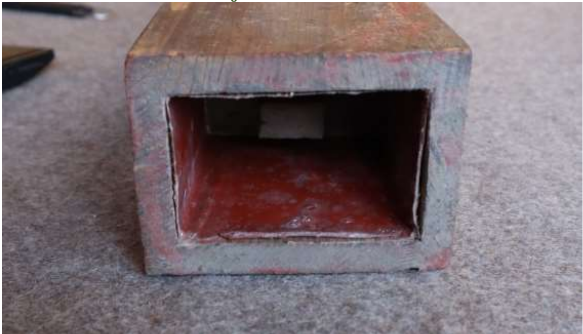
Abbildung 27 Mit dickem Bolus ausgegossene Holzpfeifen Gamba 8'
