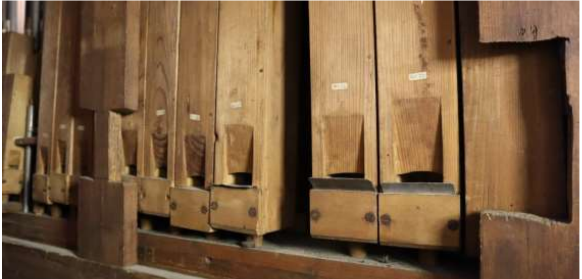
Abbildung 64 Gehäuseausschnitte zur besseren Ansprache Gedeckt 8' v.d.R.
