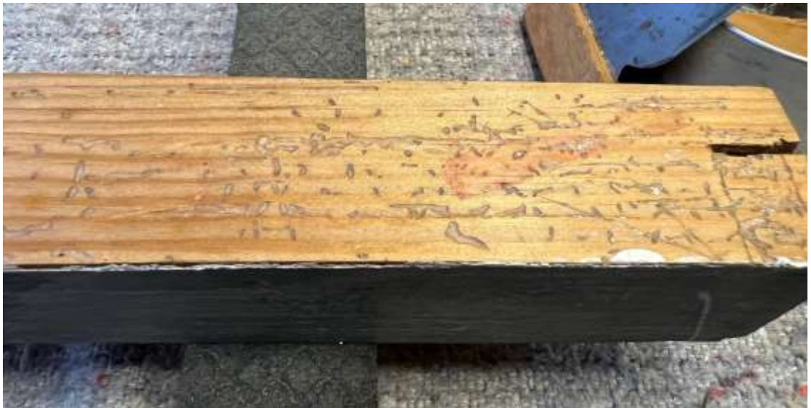
Abbildung 38 Stöcke nach der Wurmbehandlung n.d.R.
