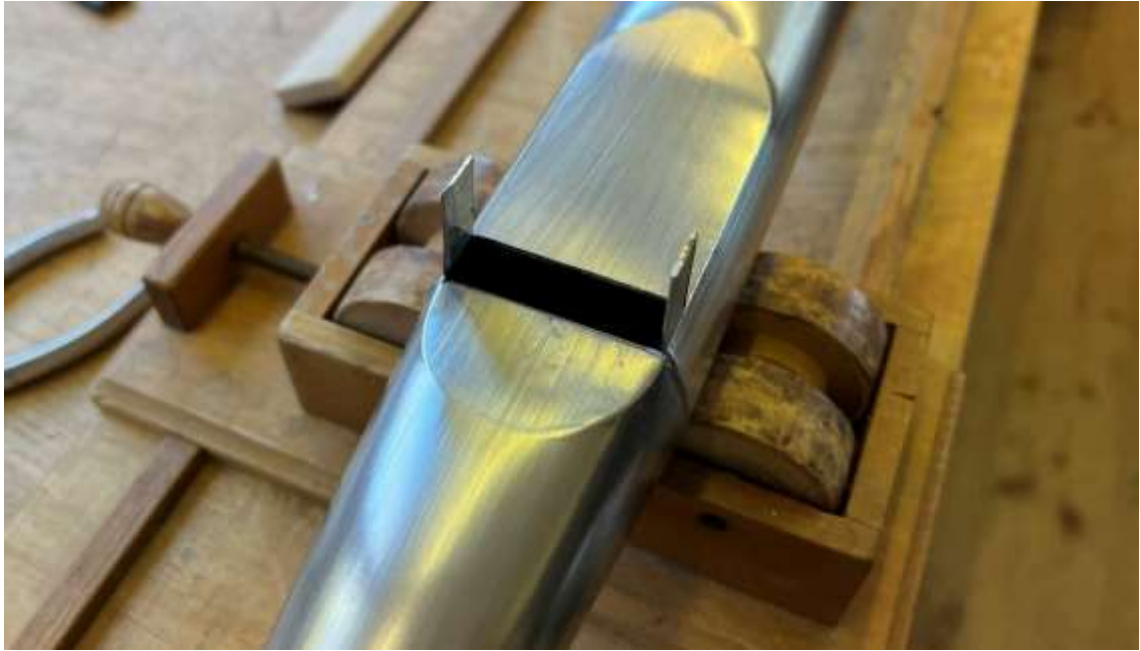
Abbildung 34 Aufschneiden der Pfeifen und Aufschnittbärte w.d.R.
