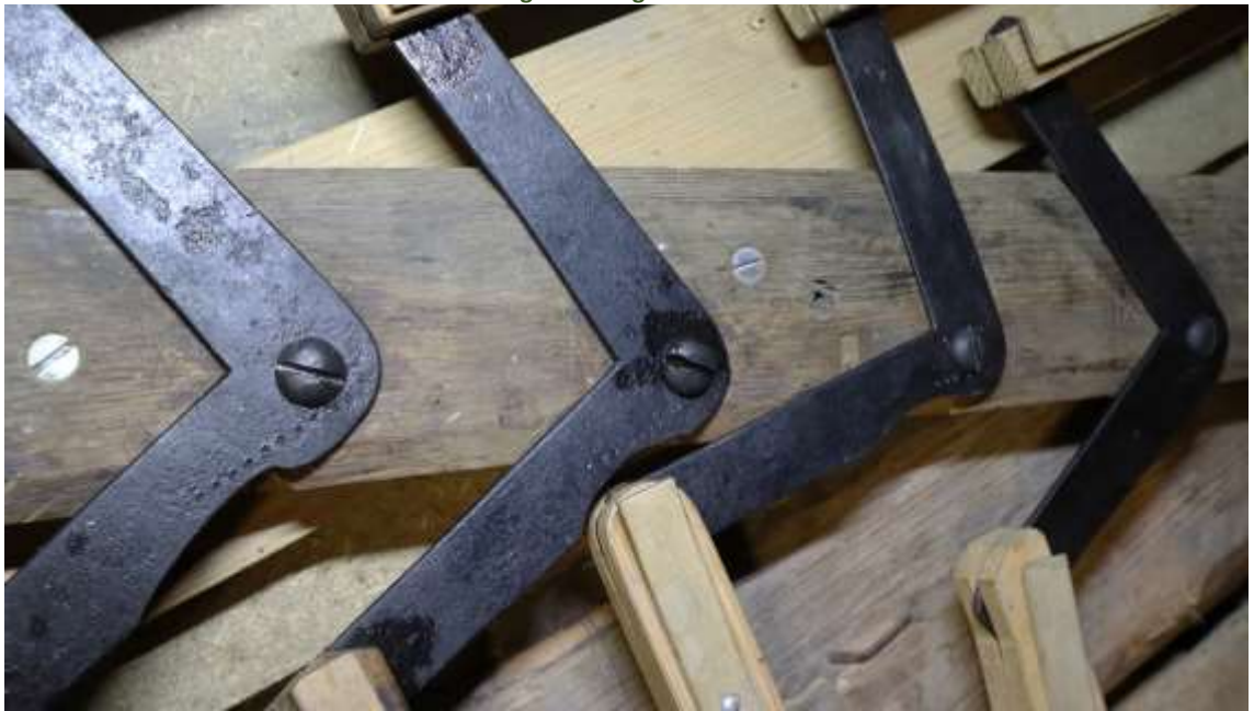
Abbildung 49 Entrostete und brünierte Eisenwinkel n.d.R.
