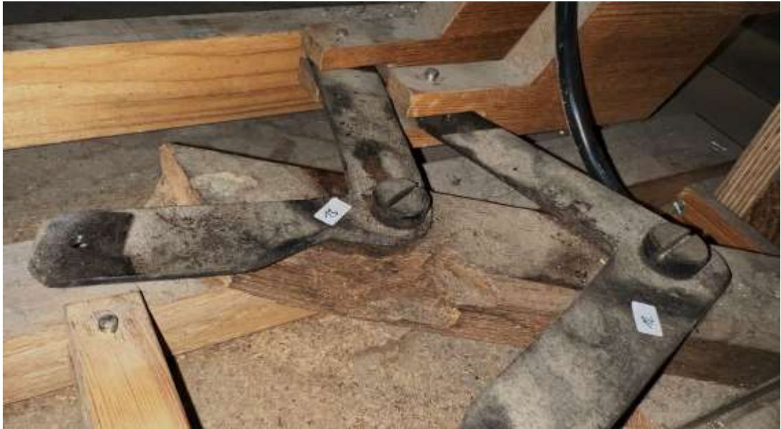
Abbildung 47 Eisenwinkel der Registermechanik v.d.R.
