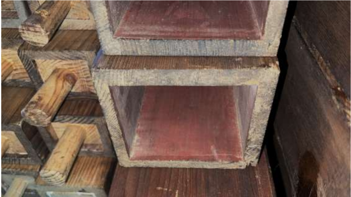
Abbildung 26 Pfeifenmündungen Hörterich-Pfeifen mit Bolusanstrich
